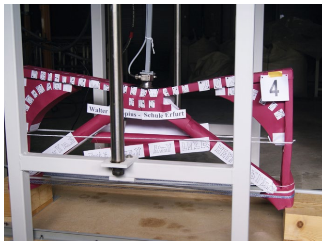
Traglasttest mittels Abdrückmaschine
