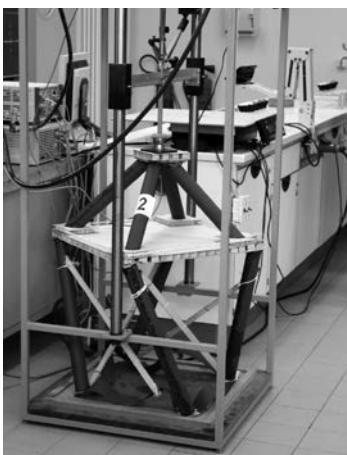
Das Dachtragwerk während des Belastungstests.
